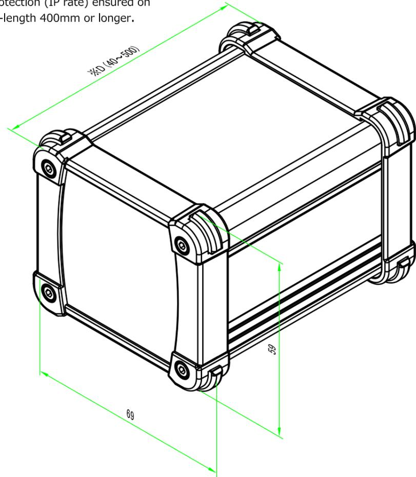
※取付ビスの締付けの強弱によりガスケットが伸縮するためD寸法(全長)は多少変化します。
